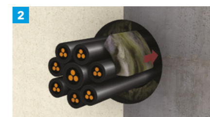
Szczelnie wypełnić wełną mineralną.
