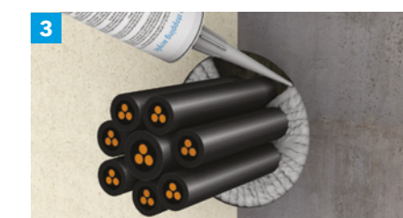
Nałożyć odpowiednią warstwę masy uszczelniającej i zapewnić dobrą przyczepność podłoża przed nałożeniem pierwszej warstwy uszczelnienia.
