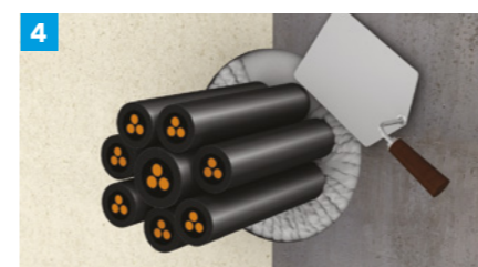
Wygładzić powierzchnię masy uszczelniającej pędzlem lub packą zwilżoną wodą zanim utworzy się sztywna powłoka.
